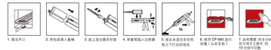
1. 清洁开口 2. 将包装滑入套桶 3. 装上混合器并拧紧 4. 将套筒插入注射器 5. 推出未混合完全的前几下打出的泡沫 6. 使用 CP 660 进行封堵 (从后至前) 7. 如有需要, 约 5 分钟后可用手工塑平, 约 10 分钟可切割
