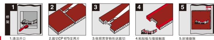
5. 用规范所允许的喜利得锚栓将 CP 675 固定在开孔表面。注意每个固定点的距离要求。当两块板一起安装使用时, 可用 FS-ONE 或 CP 619 T 粘结板表面
